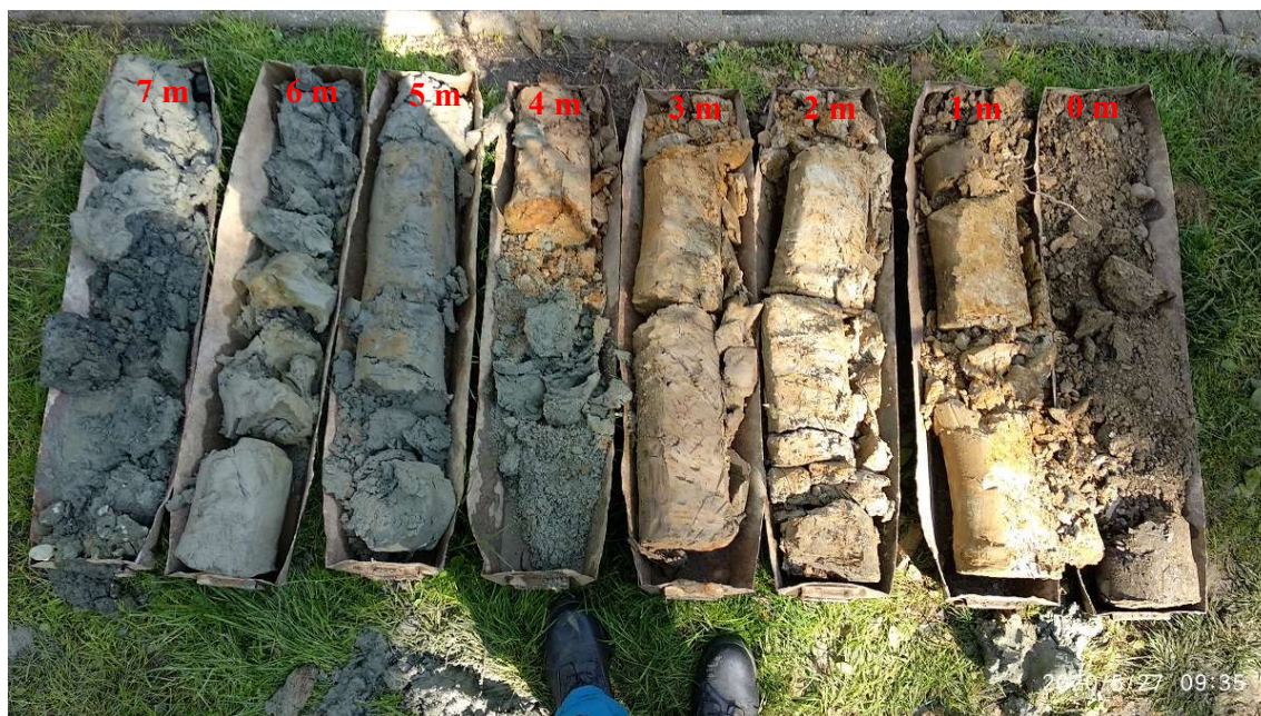
Obrázek č.2 Fotodokumentace zastížených zemin z vrtu HJ-1
