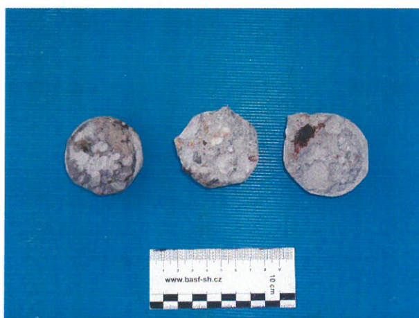
Zkušební terče po odtrhové zkoušce. Ve všech případech nastala kohezní porucha v podkladu.
