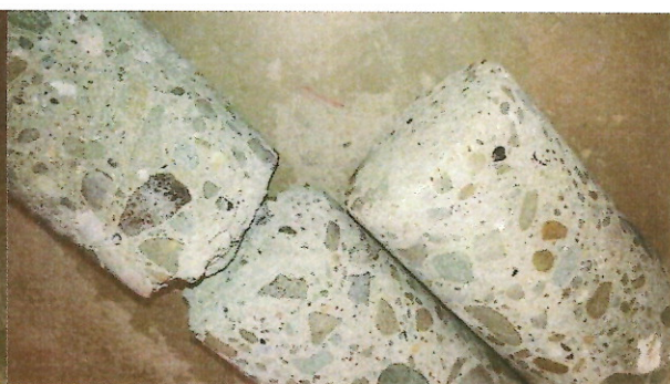
Obr. 9: Detail ukončení opěry č. 2 svislou pracovní spárou (vzorek v horní části obrázku).
