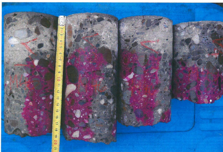
Vývrty ze spodní stavby mostu po aplikaci roztoku fenolftaleinu.
