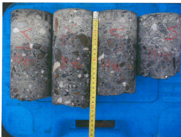
Odebrané jádrové vývrty V1, V2, V3 a V4 ze spodní stavby.
