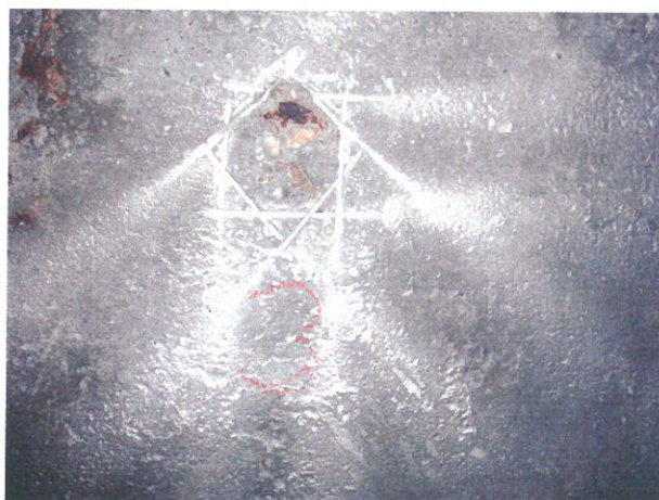
Zkušební místo číslo 3 po odtrhové zkoušce.
