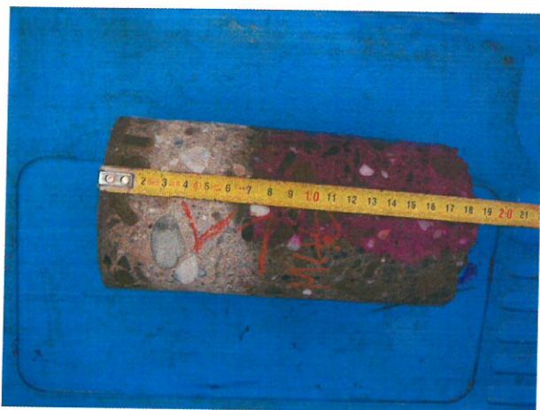
Měření zkarbonatované vrstvy betonu na vývrtnu V1 z pravobřežní opěry OP1.
