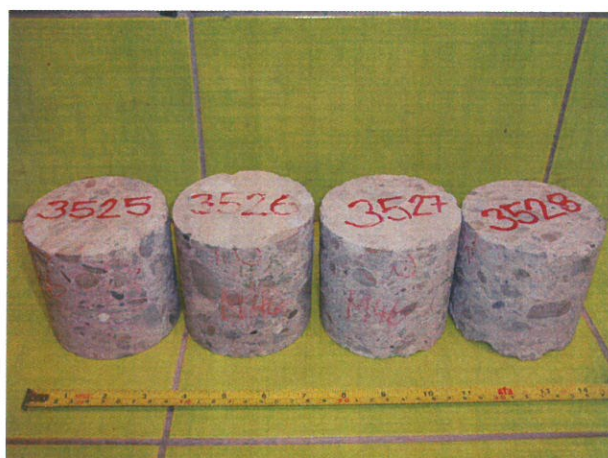
Upravená zkušební tělesa pro destruktivní zkoušku pevnosti v tlaku.
