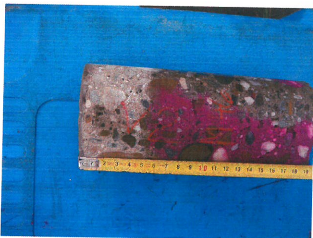
Měření zkarbonatované vrstvy betonu na vývrtnu V2 z pravobřežní opěry OP1.
