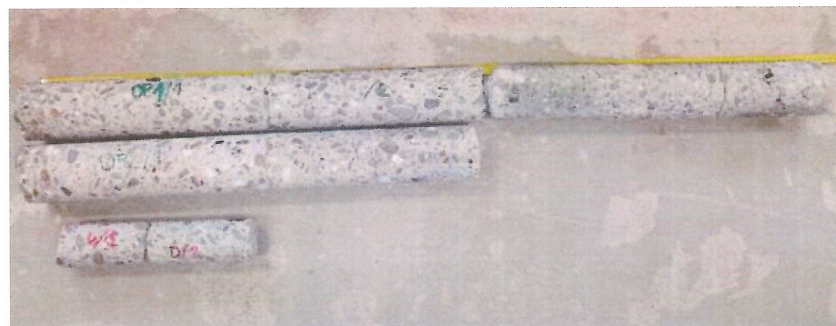
Obr. 7: Jádrové vývrty odebrané ze spodní stavby mostního objektu.
