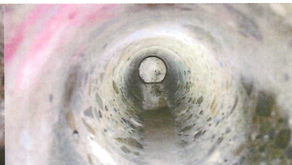
Obr. 6: Pohled do sondy po odběru jádrového vývrtnu OP2. Konstrukce opěry je v hloubce 765 mm ukončena svislou pracovní spárou.
