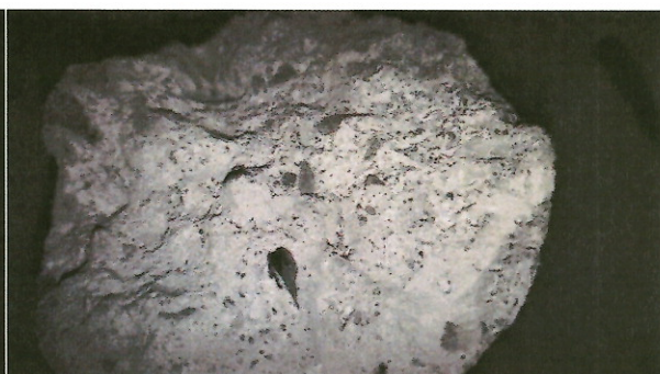
Obr. 3: Lomová plocha jádrového vývrtu OP1 s produkty síranové koroze.
