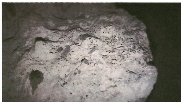
Obr. 2: Lomová plocha jádrového vývrtu OP1 s produkty síranové koroze.
