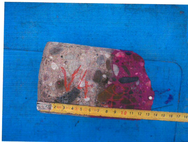
Měření zkarbonatované vrstvy betonu na vývrtnu V4 z levobřežní opěry OP2.
