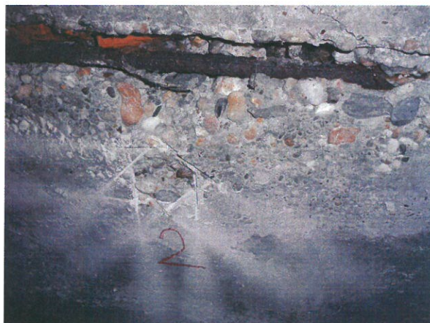
Zkušební místo číslo 2 po odtrhové zkoušce.
