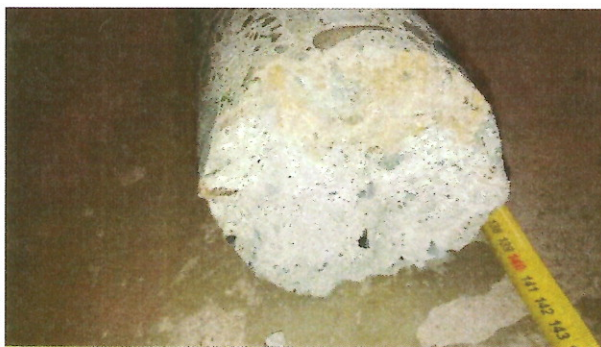
Obr. 8: Lomová plocha jádrového vývrtu OP1 v hloubce 1390 mm. Struktura betonu je narušena síranovou korozí.
