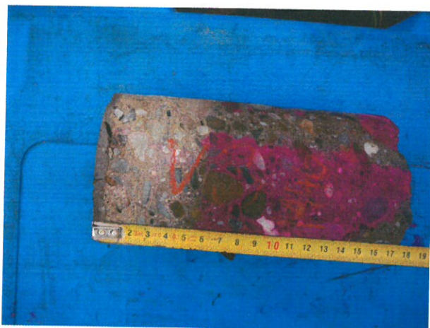
Měření zkarbonatované vrstvy betonu na vývrtnu V3 z levobřežní opěry OP2.
